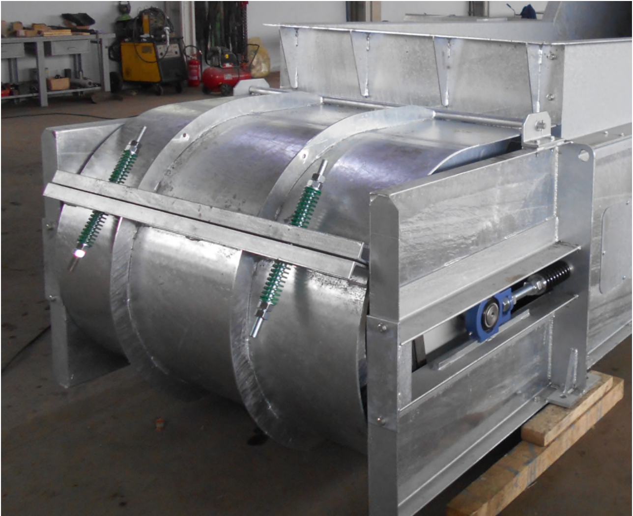
Slika 4: Poklopac mjenjača sa sponama sa oprugama
