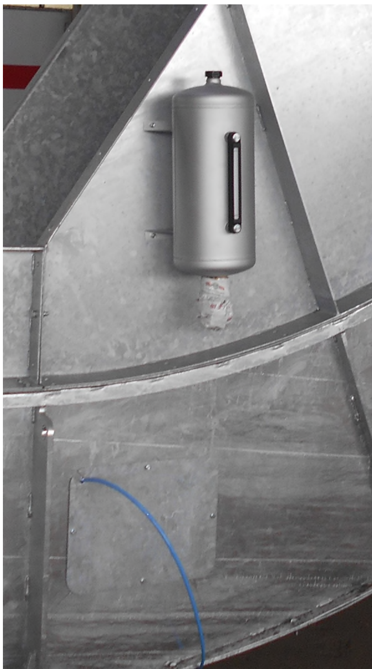
Sl.1: Sustav za automatsko podmazivanje lanca
