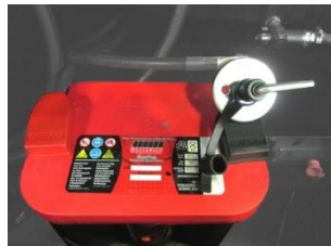
Glavni prekidač baterije montiran i na samoj bateriji
